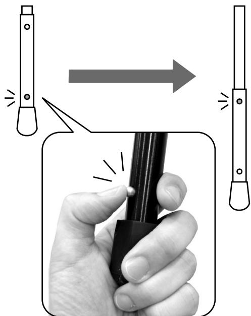
脚部フレームにあるボタンを押ながら脚を伸ばすことで高さを2段階に調整することができます。
