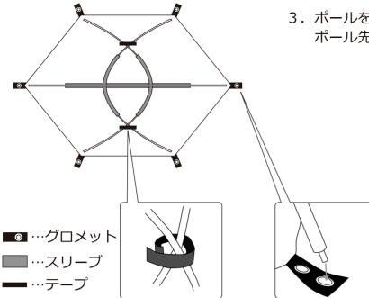
3. ポールを各スリーブに通し、左図のように ポール先端をグロメットに差し込みます。
